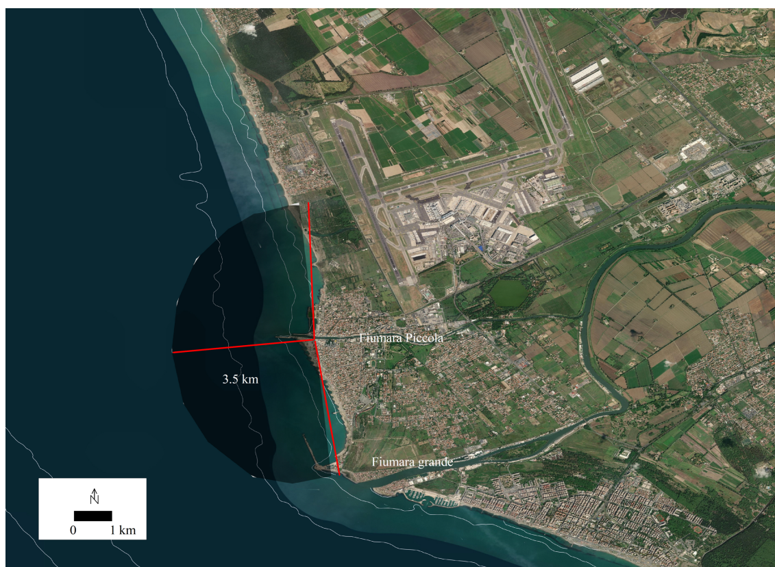
Fig.9 Area di misura del sistema radar X-Band
